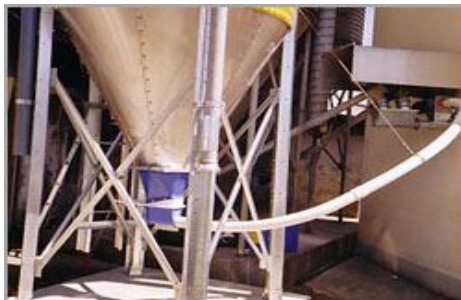
Schneckenkasten mit Spiro-Schnecke, angepasst auf horizontale Schnecke.
